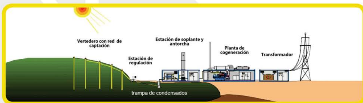
Extracción de gas en vertederos
